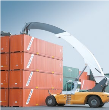
■ Beispiele für den Einsatz unserer hoch- und verschleißfesten Bleche – MAXIL® und BRINAR®: Reachstacker von Liebherr (Bild links), WM-Stadion in Durban, Südafrika (Bild Mitte), Flugzeugschlepper von Goldhofer (Bild rechts, Quelle: Fraport AG). -- Examples of the application of our high-strength and abrasion resistant steels – MAXIL® and BRINAR®: Reachstacker of Liebherr (left picture), World Cup Stadium in Durban, South Africa (center picture), Aircraft Tractor of Goldhofer (right picture, source: Fraport AG).
